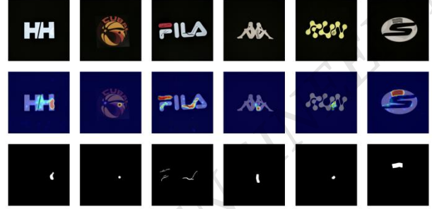
(a) 白斑 (b) 墨点 (c) 划痕 (d) 材料不良 (e) 脏污 (f) 异物
