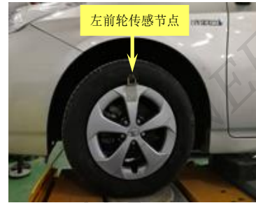
图 5 车轮参数检测模块安装位置
