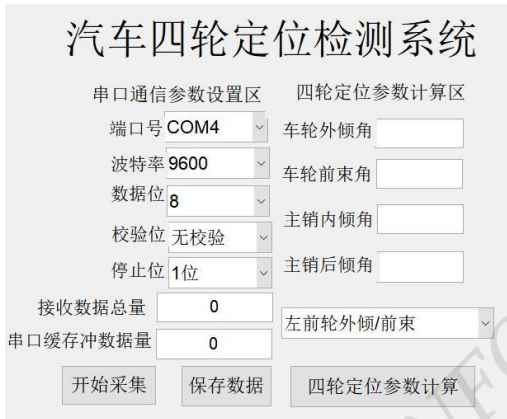
图 4 基于 MATLAB 的轮载式四轮定位参数检测系统人机交互界面
