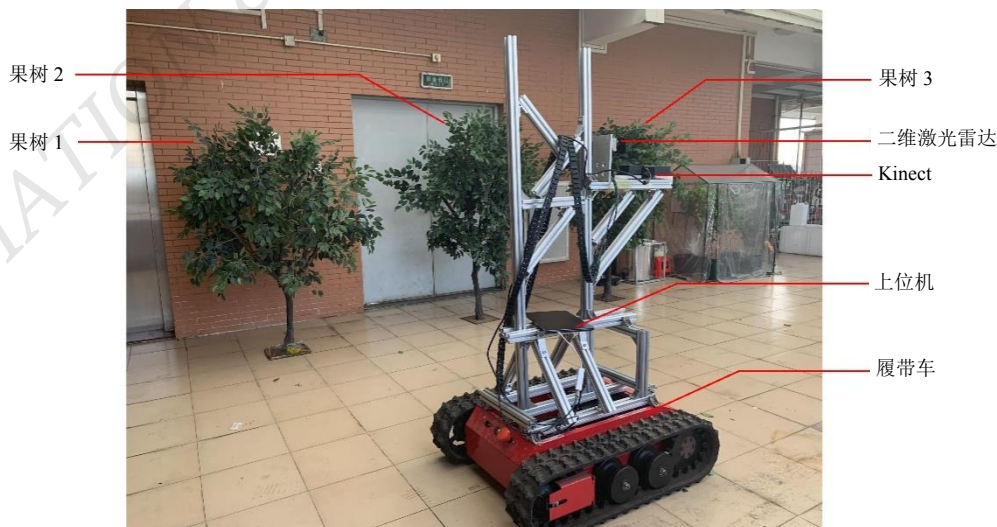
图 4 基于二维激光雷达和 Kinect 的果树冠层检测系统及实验场景布局
