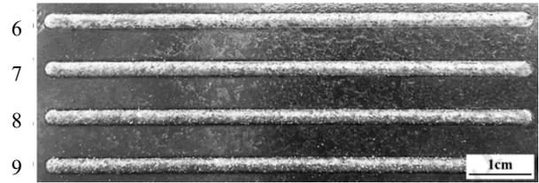
图 6 不同送粉速度下熔覆层的宏观形貌
