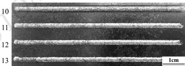
图8 不同激光扫描速度下熔覆层的宏观形貌
